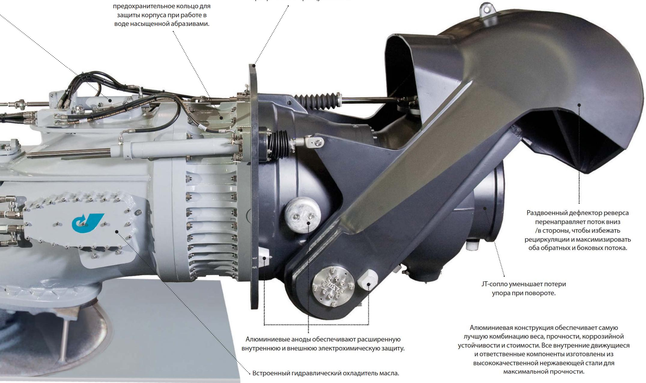
Алюминиевая конструкция обеспечивает самую лучшую комбинацию веса, прочности, коррозийной устойчивости и стоимости. Все внутренние движущиеся и ответственные компоненты изготовлены из высококачественной нержавеющей стали для максимальной прочности.
